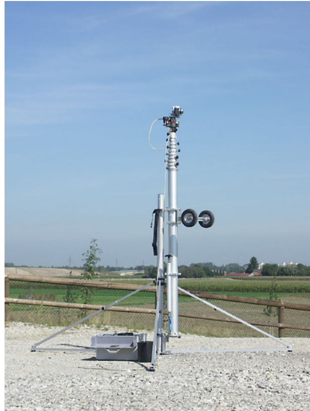
PT 150 im Stativstand mit Kamera- Fernsteuerung Remote Control 2 Zoom vor dem Ausfahren des Teleskopmastes
